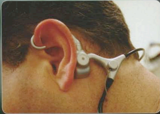
イヤホンは骨伝導技術を用いたものもある。 Some earphones utilize bone conduction technology.
